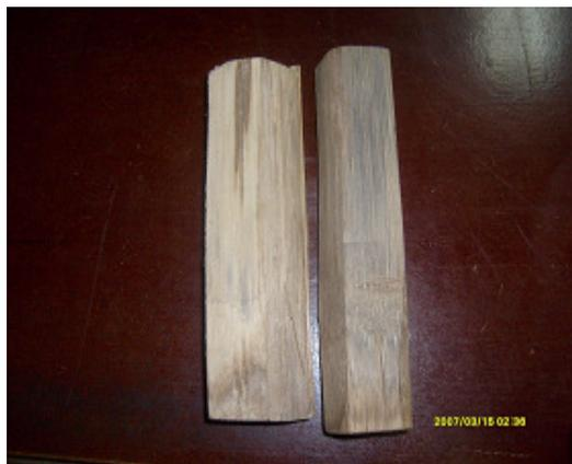
**7.4. Comparación entre probetas tratadas, ácido bórico (izquierda) y licor negro (derecha)**
