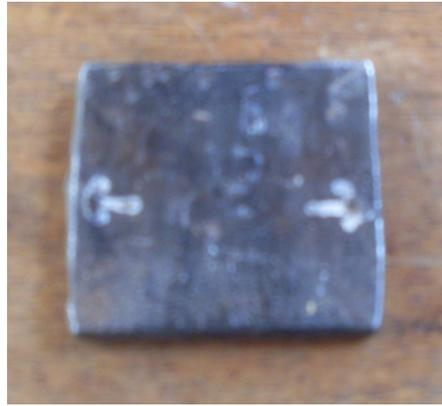
Figura 6.16. Placa utilizada en el ensayo de compresión perpendicular
