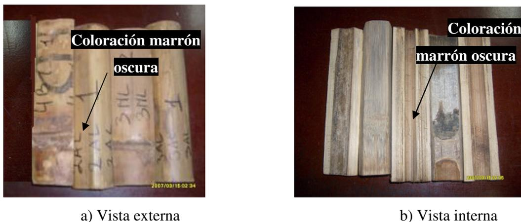
**Figura 7.3. Probetas tratadas *Guadua amplexifolia* con licor negro**
