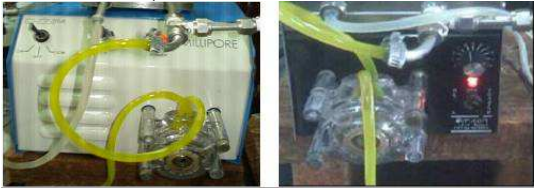
Figura V. 8 Bomba peristáltica Millipore y Micon Pump (0-10rpm)
