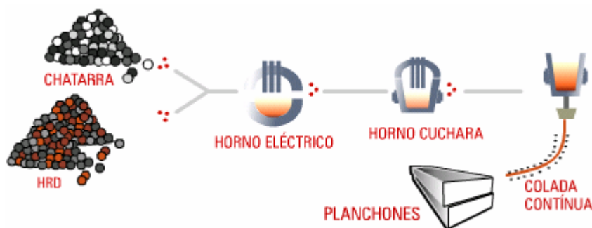
Figura 7: Proceso de la Acería de Planchones
