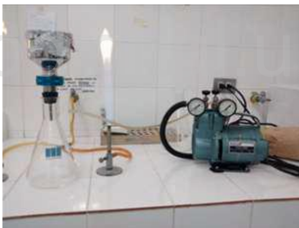
Anexo 2. Equipo de filtración y bomba de vacío
