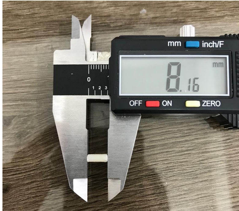
Imagen 3: Medición de las muestras, con vernier electrónico.
