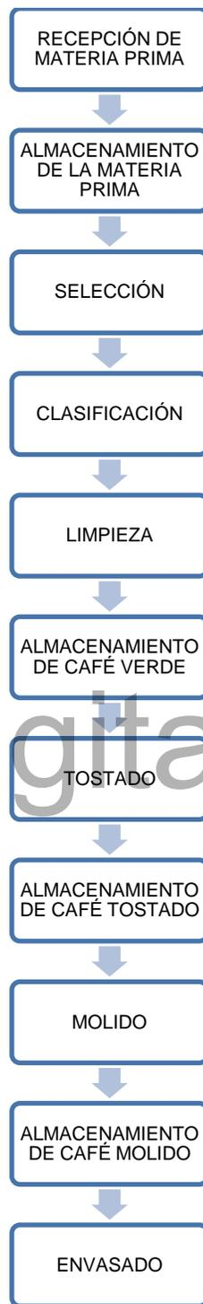
**Figura 8:** Diagrama de bloques de la elaboración de café tostado y molido
