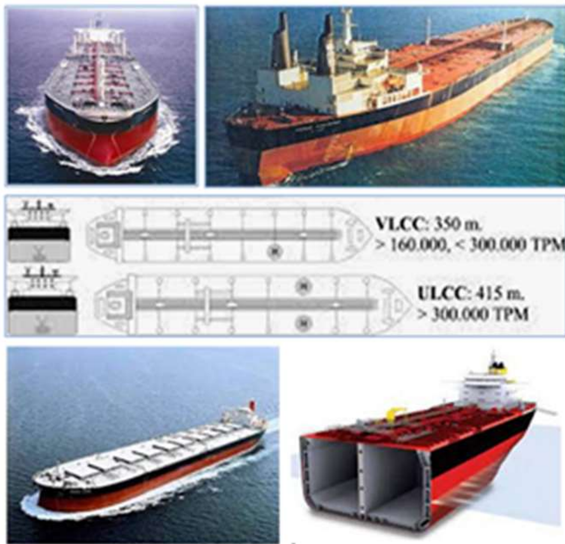
FIGURA 15. Fotografías, plantas y sección de las bodegas de un barco super tanquero petrolero/mercante con longitudes de VLCC: 350 m y ULCC: 415 m. Una vez cumplan su ciclo de vida y con las adaptaciones requeridas se puede desarrollar en los espacios internos de las bodegas desde cuatro a ocho líneas de producción de paneles termo-prensados de residuos plásticos que se obtienen por proceso de recuperación y reciclaje de las islas de plástico ubicadas en los océanos y mares. Fotografías: ingenieromarino.com; exponav.org; oa.upm.es
