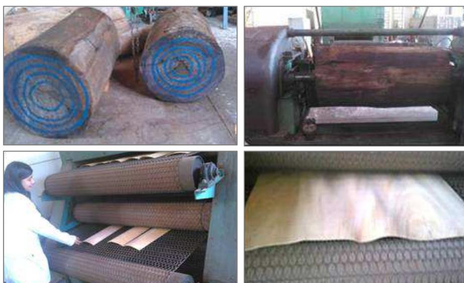
**FIGURA 1.** Vistas del proceso de obtención de las chapas del Yguire desde las rolas, torneado o debobinado y secado. Fuente: Elaboración propia.
