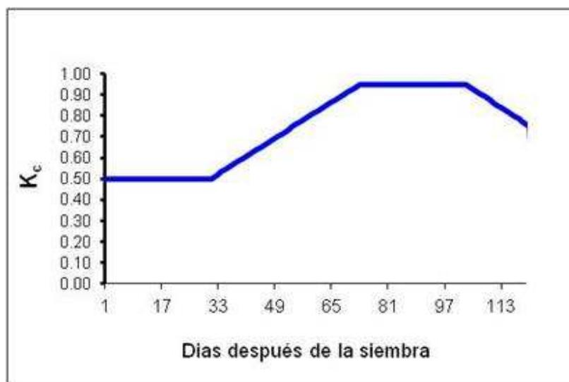
**Figura 4.3.** Curva de coeficiente de cultivo para la auyama.
