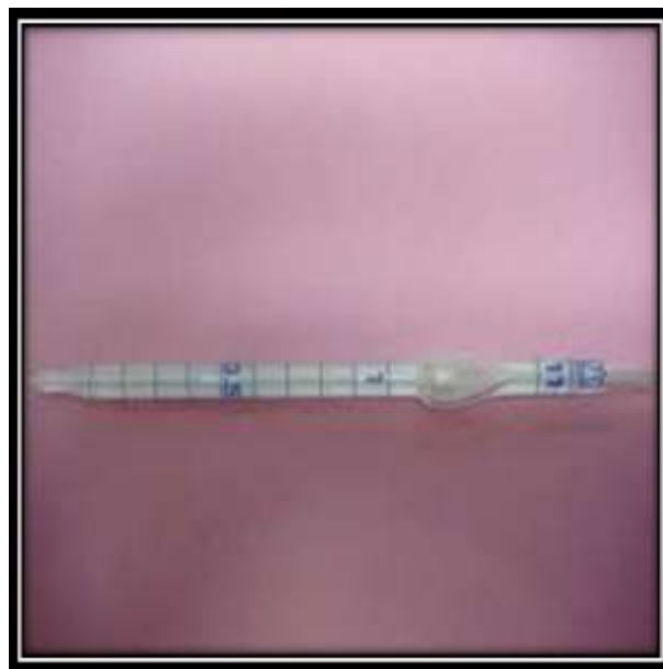
Figura 10. Pipeta tipo Thoma para Leucocitos
