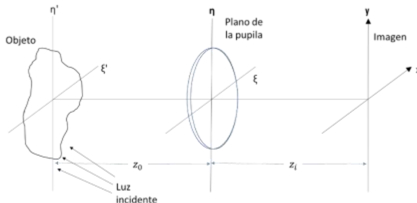
Figura 10 Geometría de formación de imagen para la formación de speckle (28).
