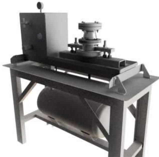
Banco de pruebas de presión con válvula de retención como elemento de prueba
