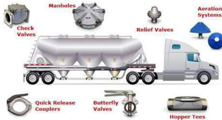
Figura 16. Esquema de accesorios del tanque (Fuente: <https://www.bulktransporter.com>)
