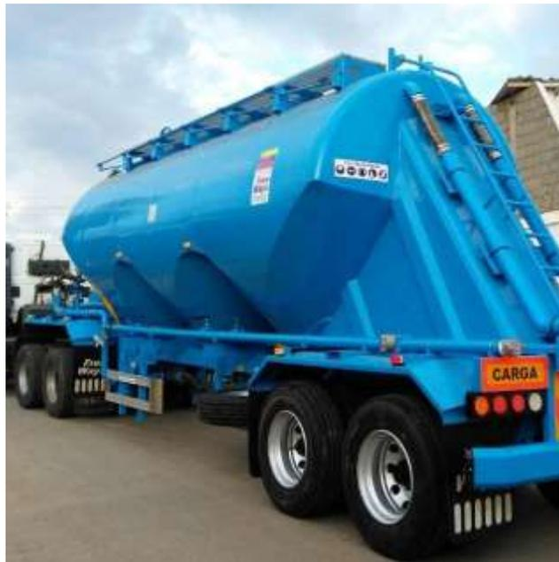
Figura 15. Tanque para transporte de polvos a granel, tipo cementero. (Industrias Free Ways C.A.)
