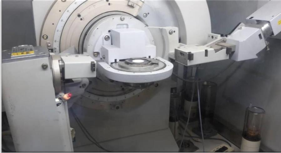
Fig. 3.4.1. Difractómetro de Polvo Siemens D5005.
