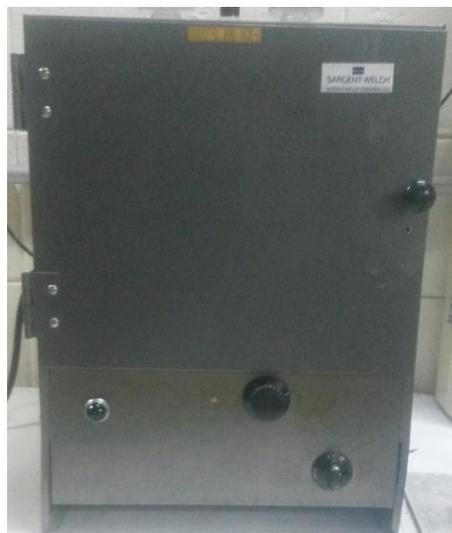
Fig. 2.4. Estufa para el secado de las muestras.
