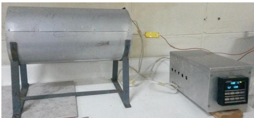
Fig. 2.6. Horno tubular usado para la calcinación de las muestras.
