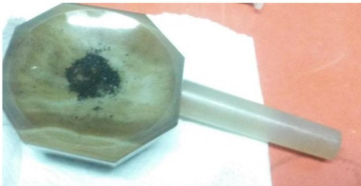
Fig. 2.5. Muestra pulverizada en el mortero de ágata.
