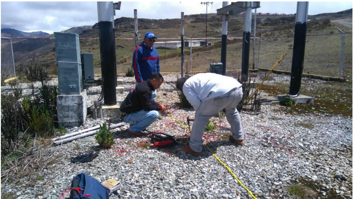
Figura A. 1 Medición de la resistencia del terreno S/E El Águila
