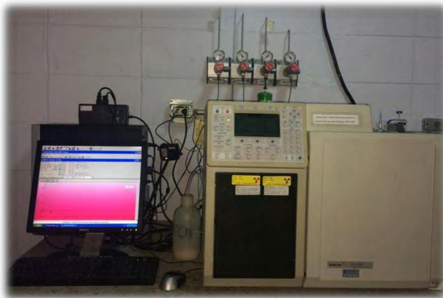
**Figura 5.** Cromatógrafo de gases Varian CP-3800
