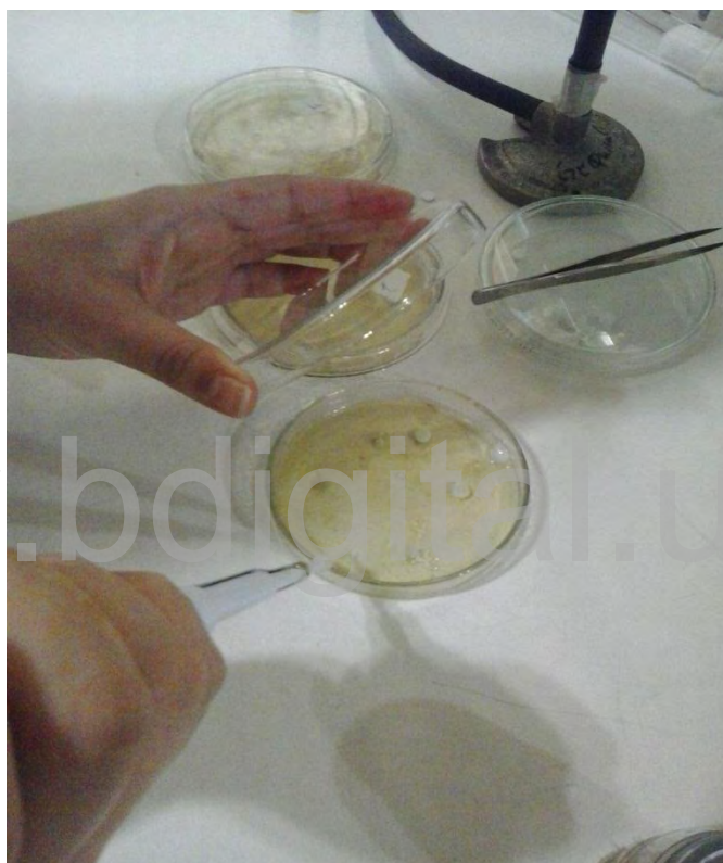
Figura III.10.- Llenado del pozo en la capsula de Petri, con 5 \mu L de la solución del exudado glandular en DMSO.
