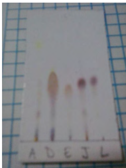
Figura II.16.- Análisis por cromatografía en capa fina de los compuestos mayoritarios del exudado glandular R. cf. adenotrichos . Condiciones de elusión: Hx:DCM 1:9 v/v.
