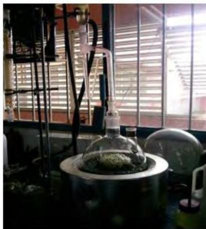
**Figura 13:** Equipo de hidrodestilación con trampa de Clevenger.
