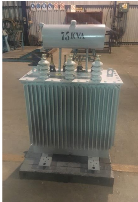
Figura 4.17 Transformador “LUISCERRANO1/19” luego de ensamblado.
