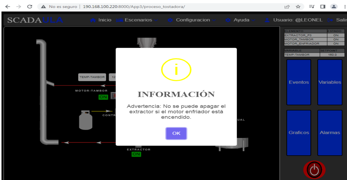
Figura N°30 Condiciones necesarias para apagar las variables del proceso 3. Fuente: autor.
