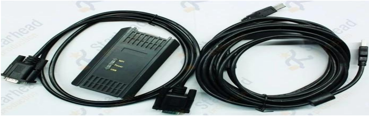
Figura N°8 Adaptador MPI/USB para Siemens S7-300. [25]
