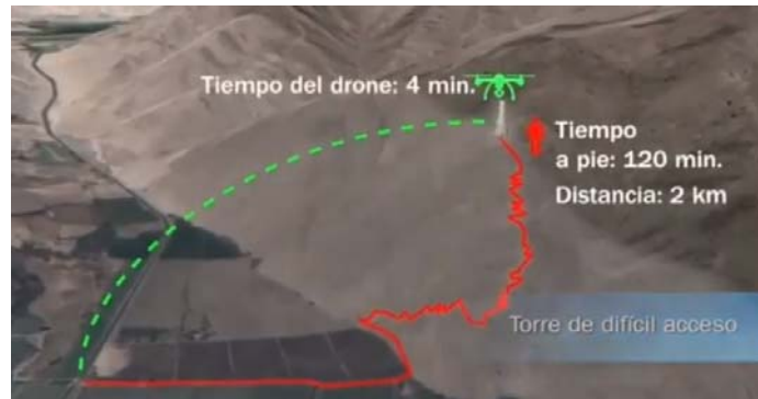
Fig. 5.9 Recorrido de un Drone por caminos de acceso para llegar a una torre [20]
