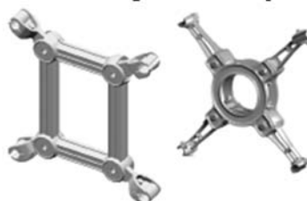
Fig. 4.19 Configuraciones para separadores de 4 conductores por fase [16].
