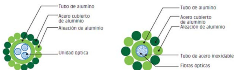
Fig. 4.7(a) Diseños comerciales para cables de guarda con fibra óptica [16].
