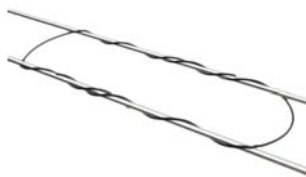
Fig. 4.16 Separador con alambre preformado rígido [17].
