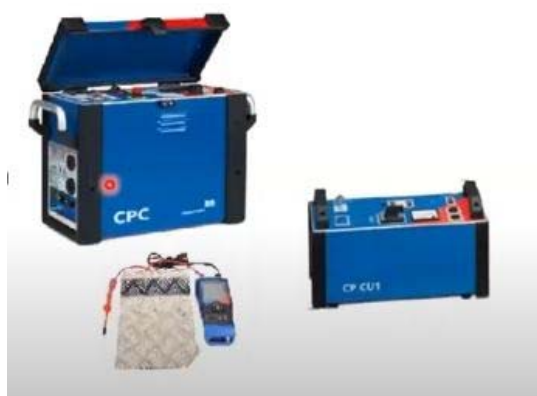
Fig. 5.15 Equipos empleados para las mediciones de puesta a tierra [20].
