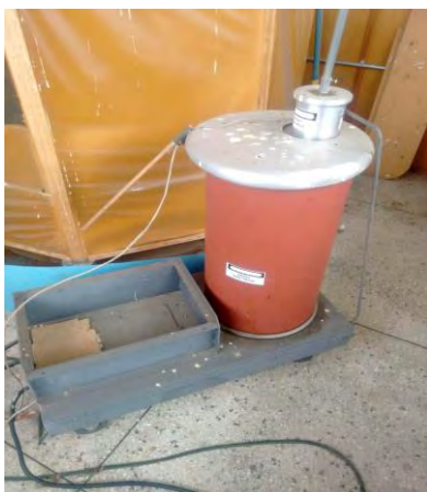
Figura 3.20. Conjunto de Alto Voltaje. Fuente: Elaboración propia.
