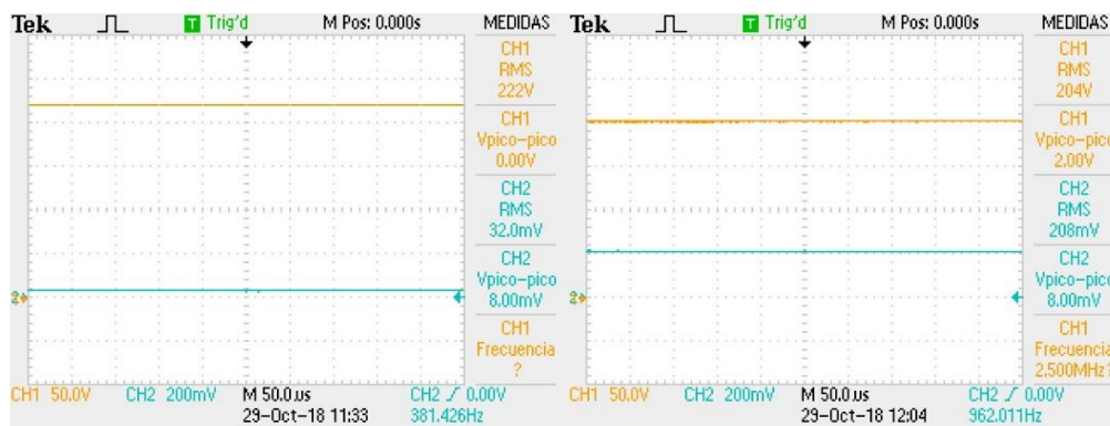
Gráfico 3.60 Voltaje y corriente condición en vacío (MCCI)
