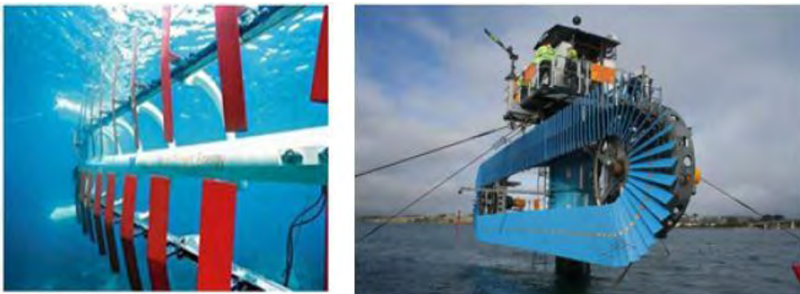
Figura 2.9: Turbinas Aquanator™ y Nereus™. Fuente: google imágenes.
