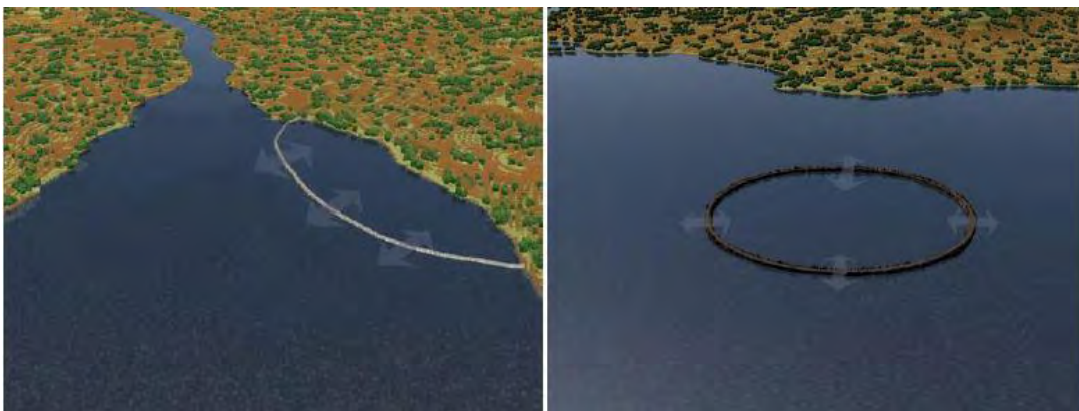
Figura 2.5: Disposiciones de la tecnología lago de marea [6].
