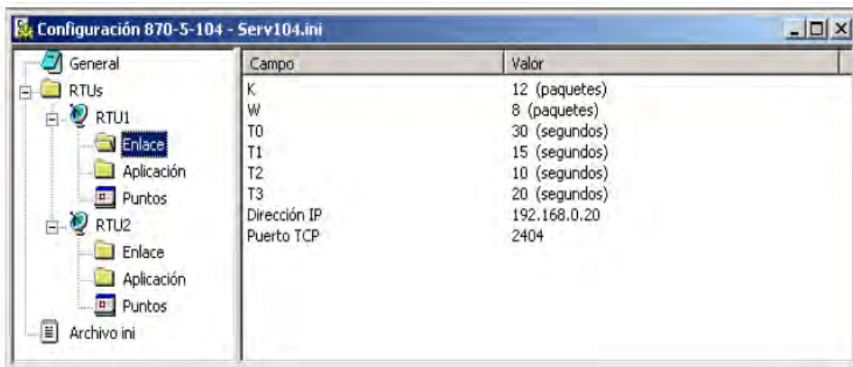
Figura 23. Interfaz gráfica en la configuración de enlace del protocolo con la RTU. [25].
