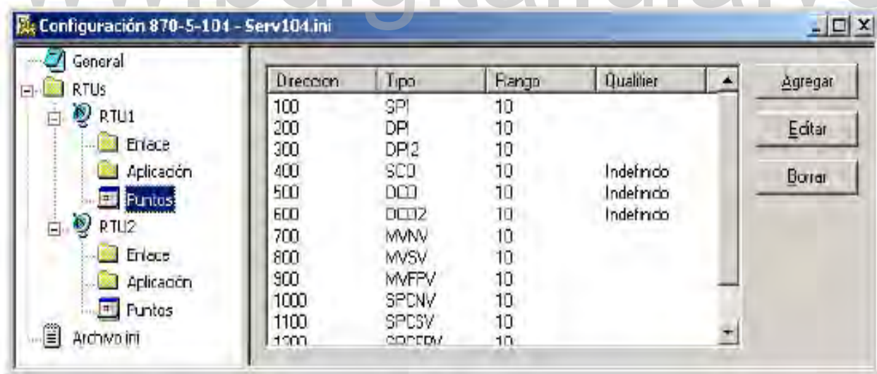
Figura 25. Interfaz gráfica en la configuración de puntos del protocolo con la RTU. [25].
