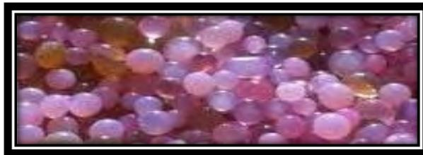
**Fig. 4.5. Silicagel totalmente húmedo. Fuente: [7]**
