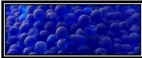
**Fig. 4.4. Silicagel parcialmente húmedo. Fuente: [7]**
