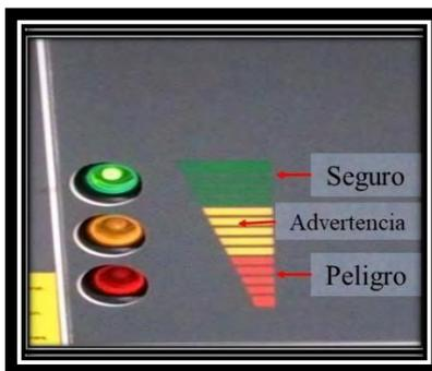
**Fig. 4.2. Indicadores de sf6 del interruptor de potencia hd4.**
