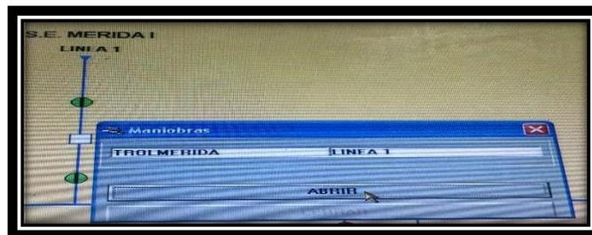
**Fig. 5.19. Maniobra a ejecutar sobre el disyuntor H-105.**
