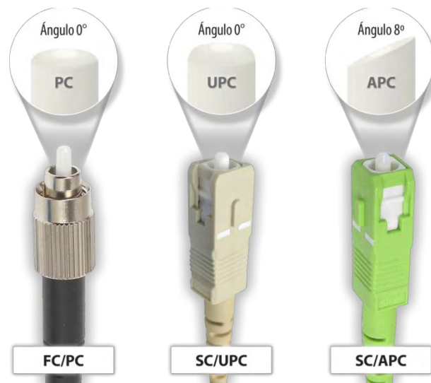
Figura 3.9. Pulido de férula en conectores [11].
