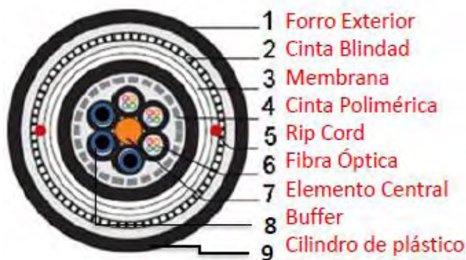
Figura 3.2. Cable de Fibra óptica de estructura holgada 9 [7].
