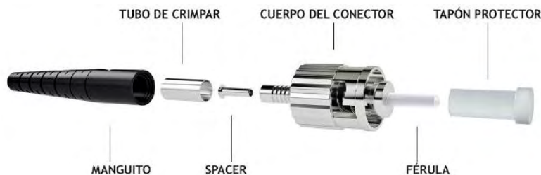
Figura 3.6. Partes de conector ST [8].
