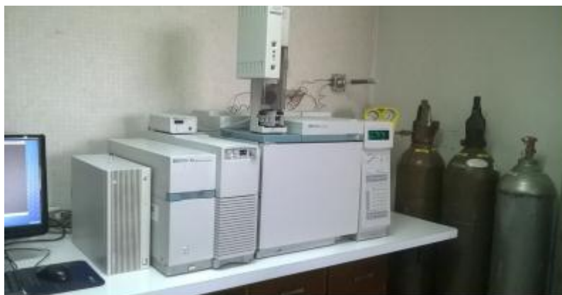
Figura N° 11. Cromatografo de gases acoplado a un Espectrómetro de masas (CG-EM). Hewlet Parckard MSD modelo 5973.
