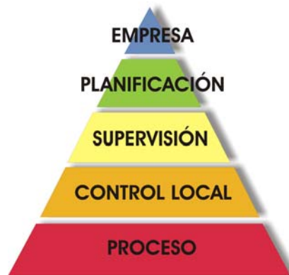
Figura 7. Modelo de plataforma de automatización ISO/OSI
