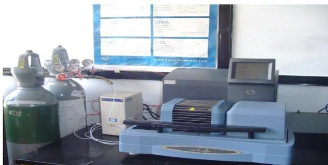
**Figura II.5.** Analizador térmico (TA Instruments modelo SDT Q600 (1500 °C ))
