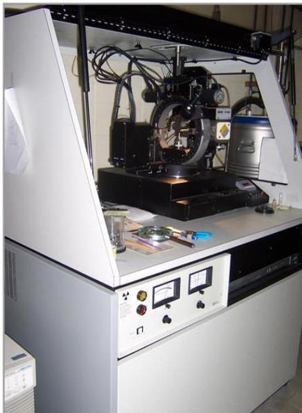
**Figura II.8.** Difractómetro automatizado Nicolet P3/F con detector puntual de centelleo
