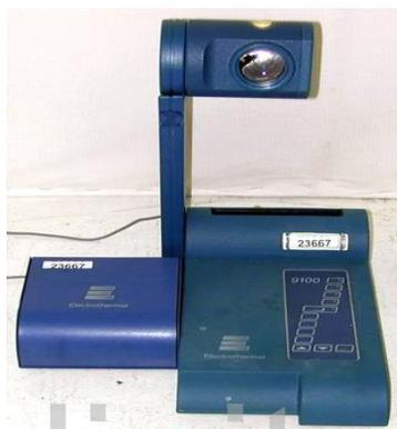
Figura II.1. Fusiómetro Engineering LTD (modelo Electrothermal 9100)
