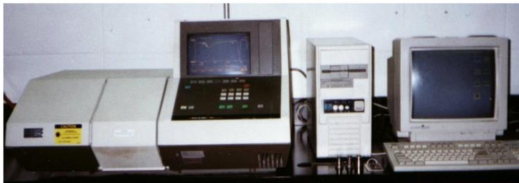
**Figura II.2.** Espectrofotómetro IR, modelo 1600 (software IRDM)
