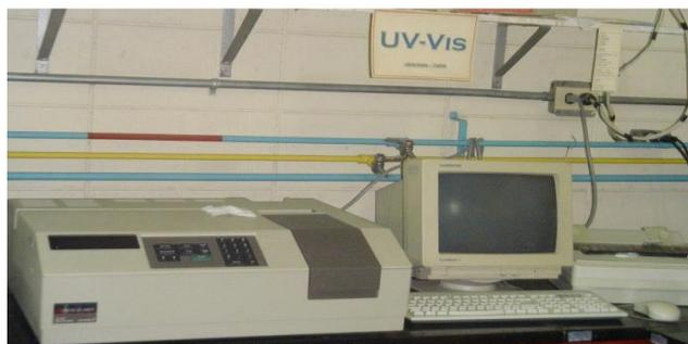
**Figura II.4.** Espectrofotómetro UV (Perkin Elmer Landa 2)
