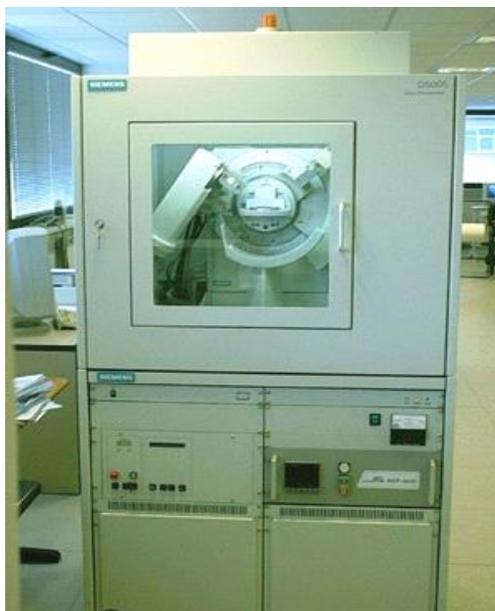
**Figura II.6.** Difractómetro Siemens D5005
