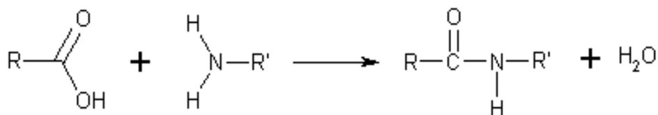
**Figura I.19.** Síntesis de amidas a partir de un ácido carboxílico y una amina
