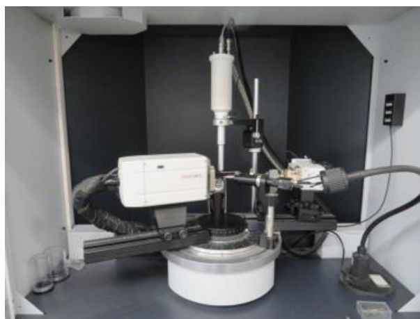
Figura III.7. Difractómetro Bruker Smart Apex II con detector CCD perteneciente al Centro de Investigación en Ciencias Aplicadas y Tecnología Avanzada (CICATA) del Instituto Politécnico Nacional de México.
