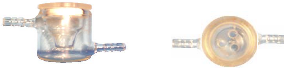
Figura 27: Celda de un compartimiento para tres electrodos.
