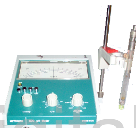
Figura 33: pHmetro marca metrohm modelo 620.
