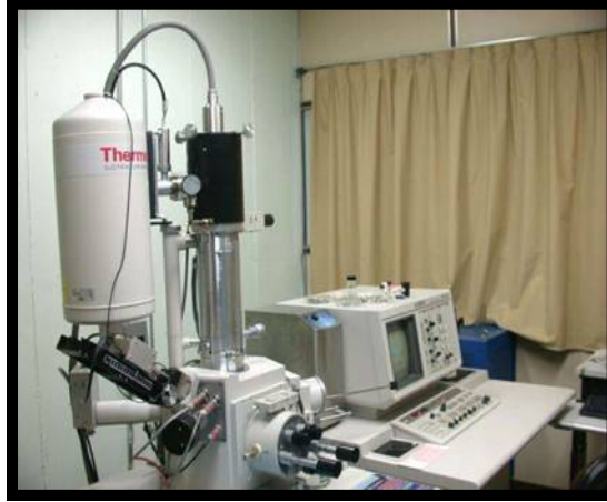
Figura 37: Microscopio electrónico marca HITACHI modelo S-2500.
