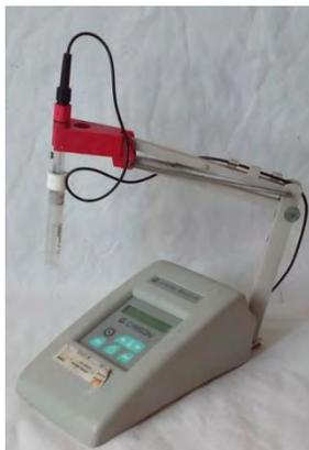
Figura I. pHmetro marca Crimson, modelo Basic 20, actualmente disponible en el Laboratorio de Análisis Instrumental, Departamento de Química (ULA).
