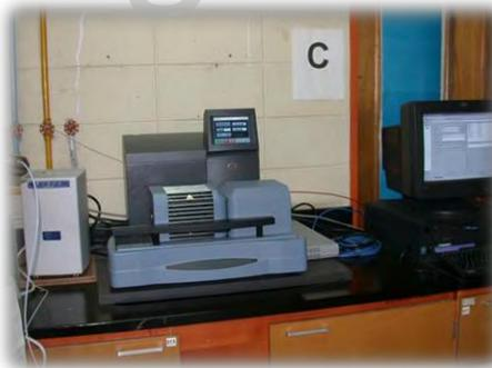
Figura 35. Equipo de Termoanálisis Mettler modelo SDTQ600.
