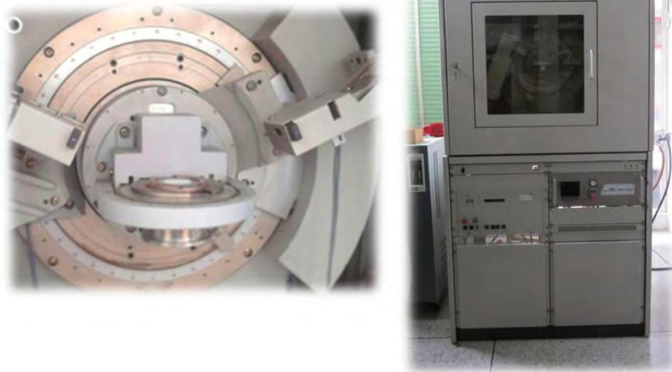
Figura 37. Goniómetro y Difractómetro de Polvo *Siemens D5005* del Laboratorio de Cristalografía-LNDRX (ULA).
