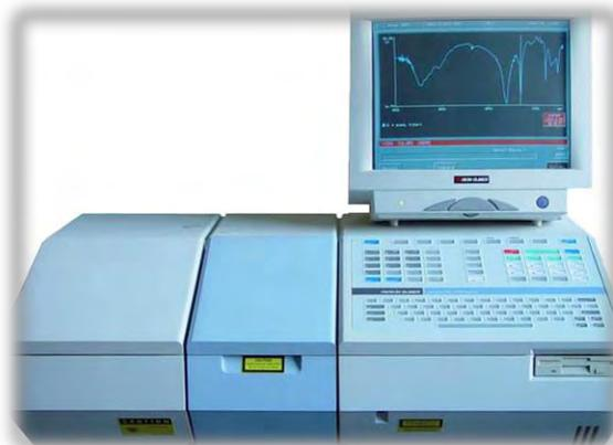
Figura 32. Espectrofotómetro *Perkin Elmer* RX1 del Laboratorio de Orgánica de la Universidad de los Andes (ULA).
