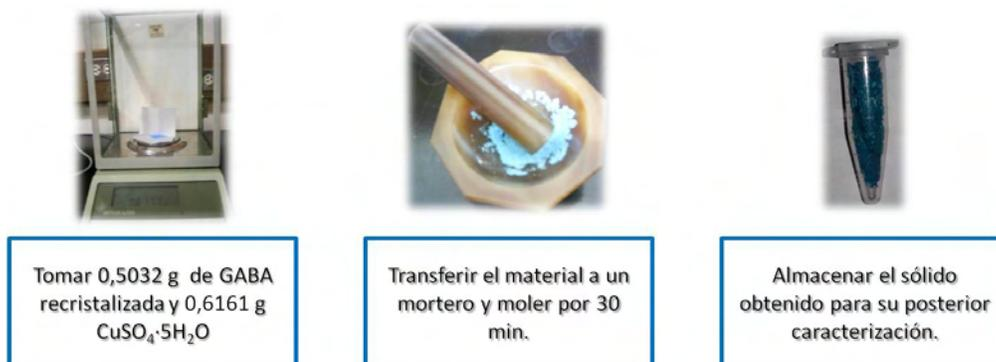
Figura 28. Diagrama de la síntesis del derivado Cu-GABA2 azul.
