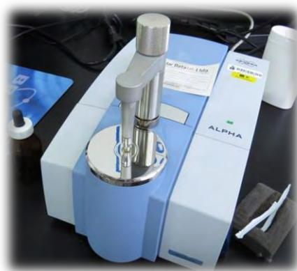
Figura 33. Espectrofotómetro *ATR* Bruker Alpha del Laboratorio de Química Orgánica y Biomolecular (LQOBio) Universidad Industrial de Santander (UIS).
