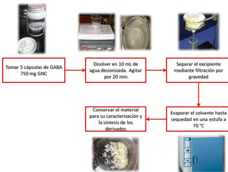
Figura 24. Diagrama del procedimiento de extracción del *GABA*.
