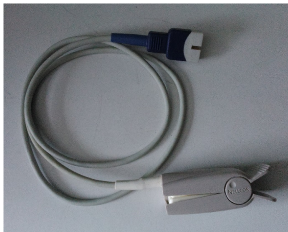
Figura 3.2. Sensor de oximetría por transmisión
