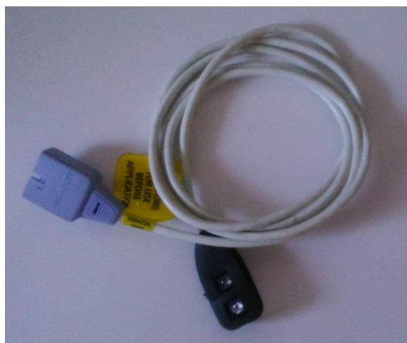
Figura 3.3. Sensor de oximetría por reflexión
