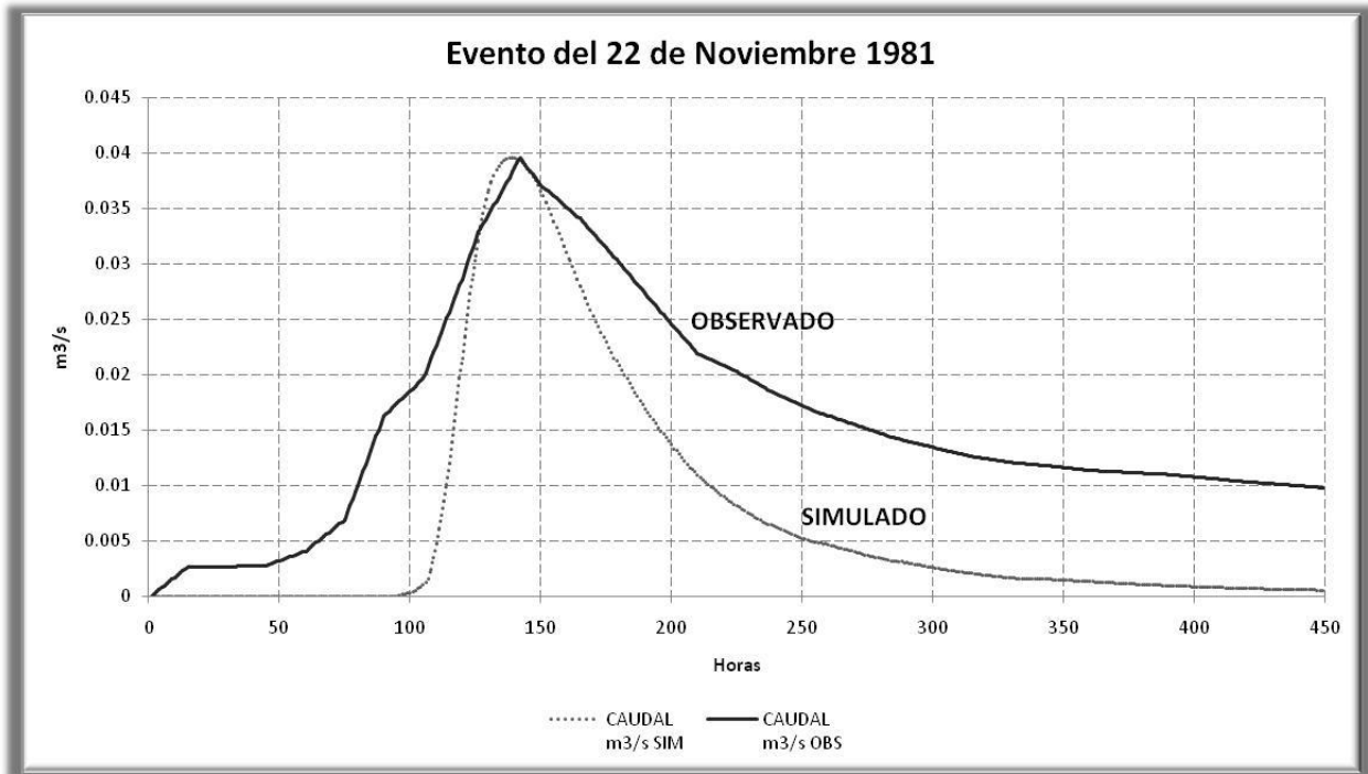
Figura 37. Resultado de la calibración del modelo EVENTO para la microcuenca La Valencia
