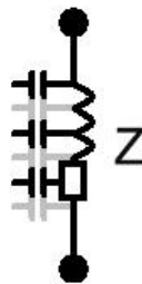
Figura 3.5 Modelado de la impedancia característica en ATP.
