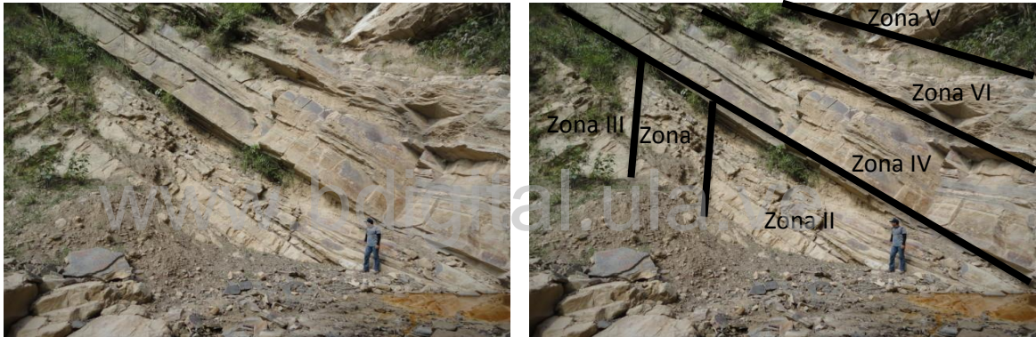
Figura 4. 8 Zonificación del talud número 2 en función del análisis del RMR
