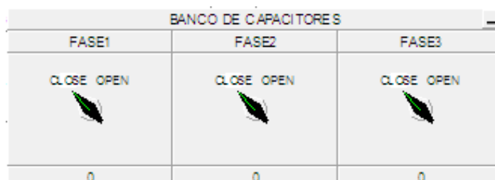
Figura 4.4 Módulo de control para el banco de capacitores.
