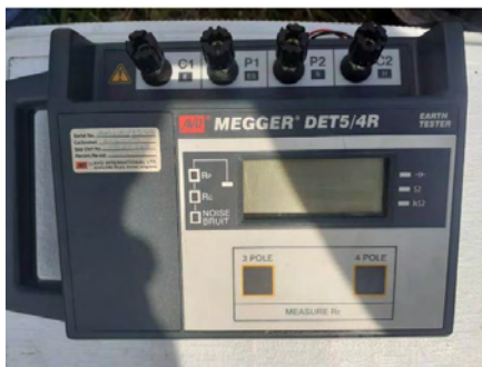
Figura 3.12 Instrumento de trabajo en resistividad
