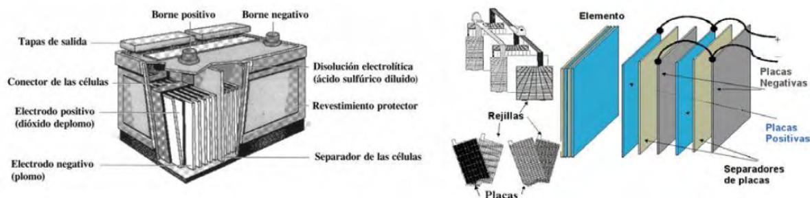
Figura 2.4 Esquema básico de una batería de Pb-a [2].
