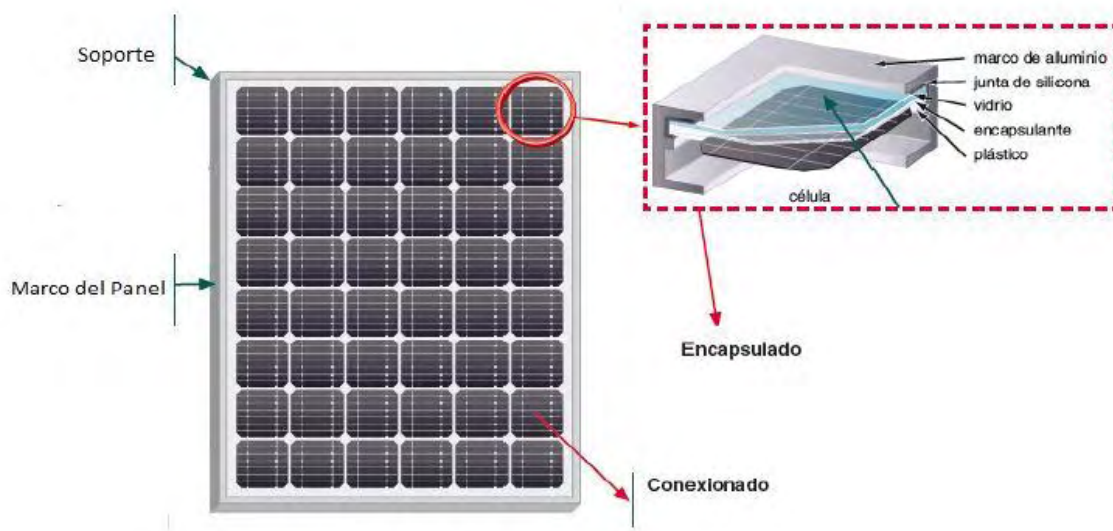
Figura 2. 2 Estructura de un panel solar [18].
