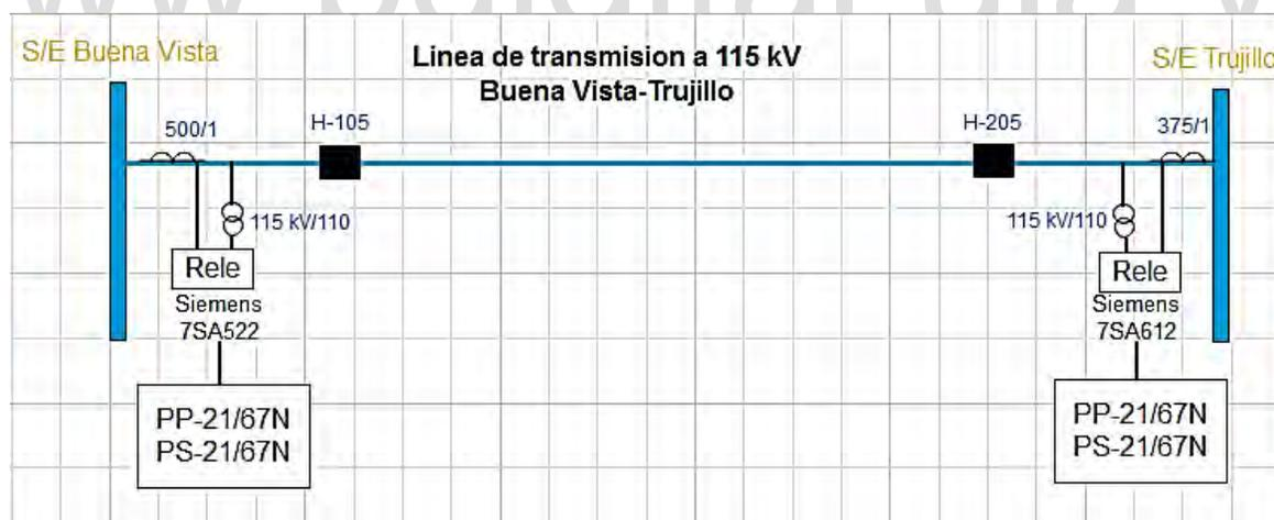
**Figura 5.2. Esquema de protección para la línea S/E Buena Vista – S/E Trujillo. Fuente: Autor.**
