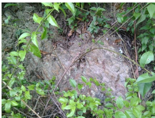
Figura 44. Progresiva 8+800. Afloramiento sobre el que se midieron los ángulos de rumbo y buzamiento de la foliación. R= S65^{\circ}W ; B=20^{\circ}
