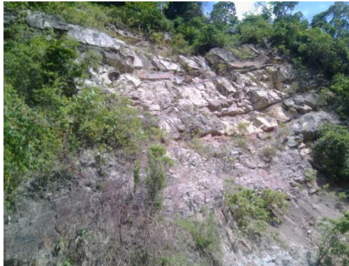
Figura 49. Progresiva 14+300. Formación Palmar. Planos de estratificación. Ángulos de Rumbo y Buzamiento: R= S30°E; B=16°
