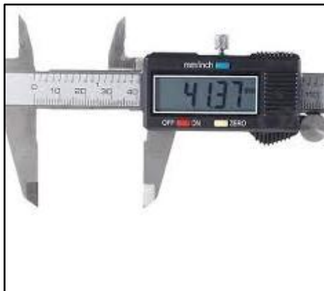
Figura 4: Vernier digital Truper®. Fuente: propia.
