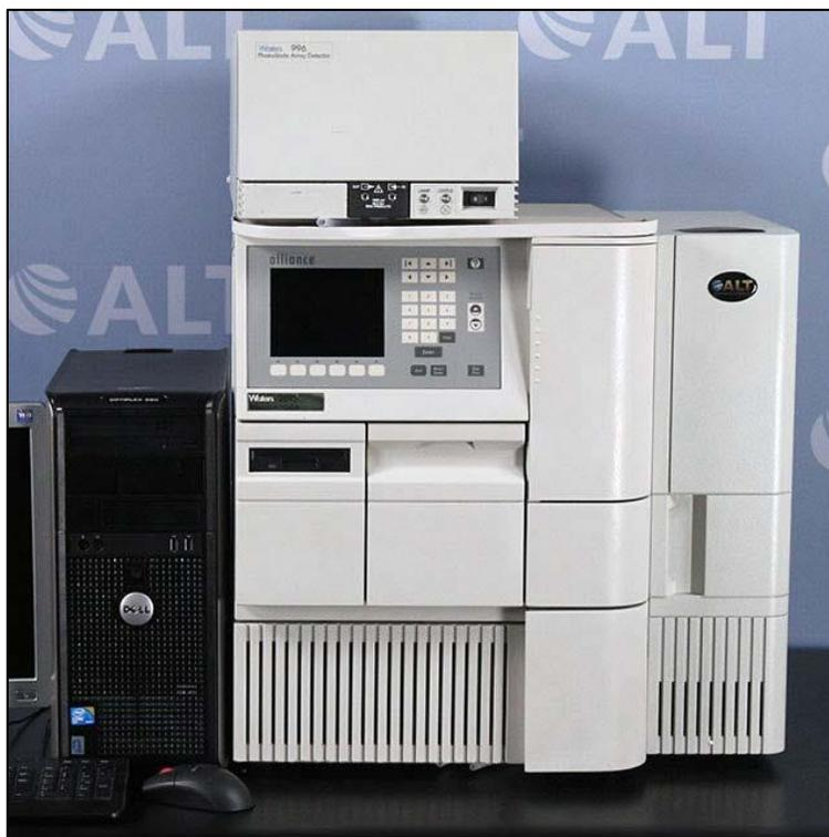
**Figura N° 28. Equipo cromatográfico Waters Alliance 2690 empleado. Conectado a un módulo detector Waters 996 con arreglo de diodos.**
