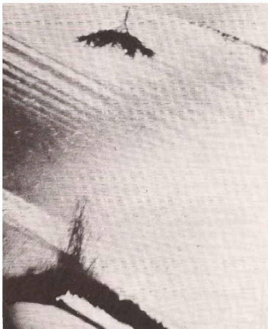
Figura 2.7. Fotografía de árboles generados a partir de asperezas alrededor de capas semiconductoras de un cable XLPE (Toshikatsu y Greenwood, 1983).
