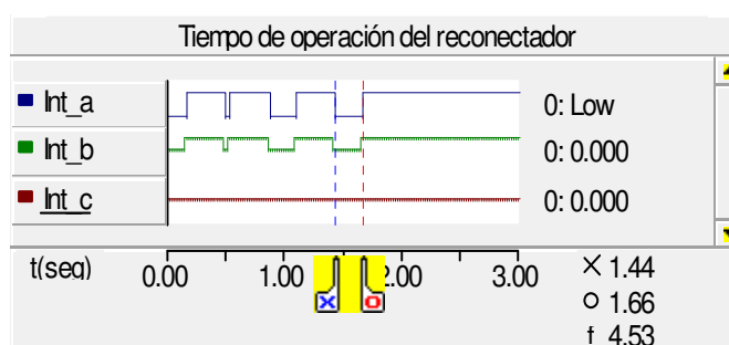
Gráfica 3.11. Tiempos de operación del reconectador ante una falla bifásica
