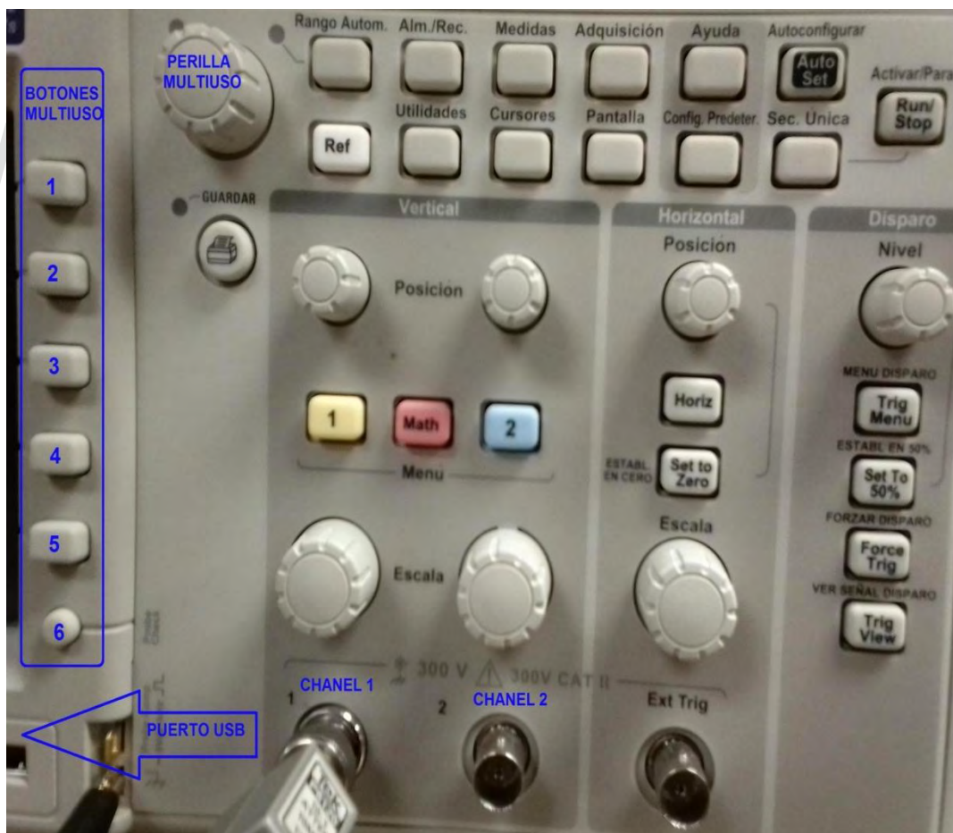
Figura 4.2 Controles Básicos del Osciloscopio. [3]
