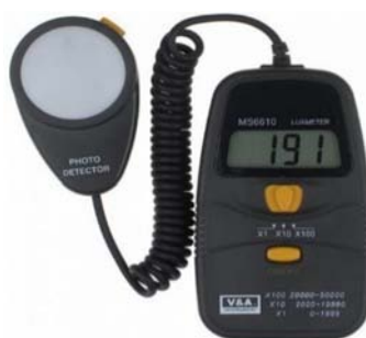
Figura 2.3. Luxómetro instrumento utilizado en las mediciones
