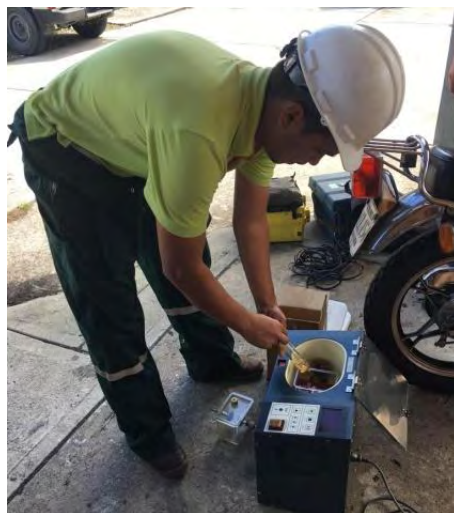
Figura 4.8 Colocación de la muestra de aceite del transformador en estudio en medidor de rigidez dieléctrica
