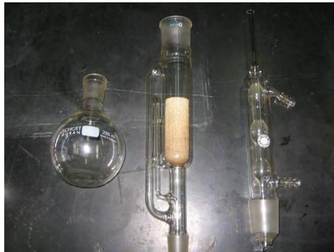
Figura III.4. Equipo de extracción Soxhlet (b)
