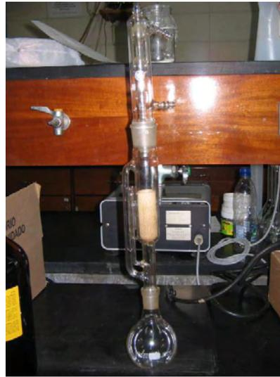
Figura III.3. Equipo de extracción Soxhlet (a)
