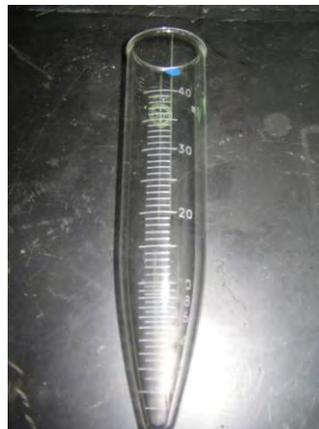
Figura III.8. Tubos de vidrio de tipo zanahoria de 50 ml para centrifuga
