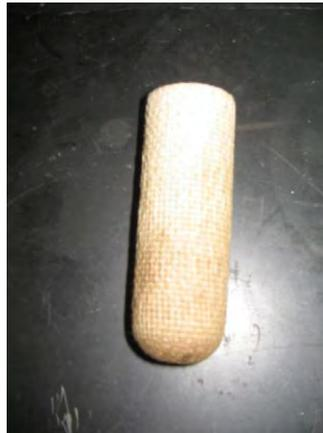
**Figura III.5. Dedales para el equipo de extracción Soxhlet, marca Whtaman
