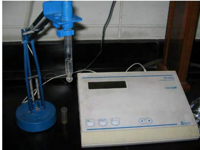
Figura III.7. pH-Metro pHM210. Standard pH meter. Meterlab
