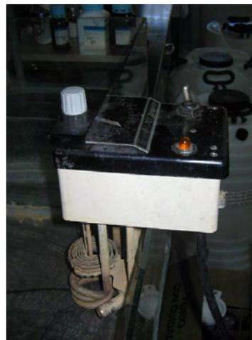
**Figura. III.2. Termostato TECAM® Rango 15°C-95°C.**
