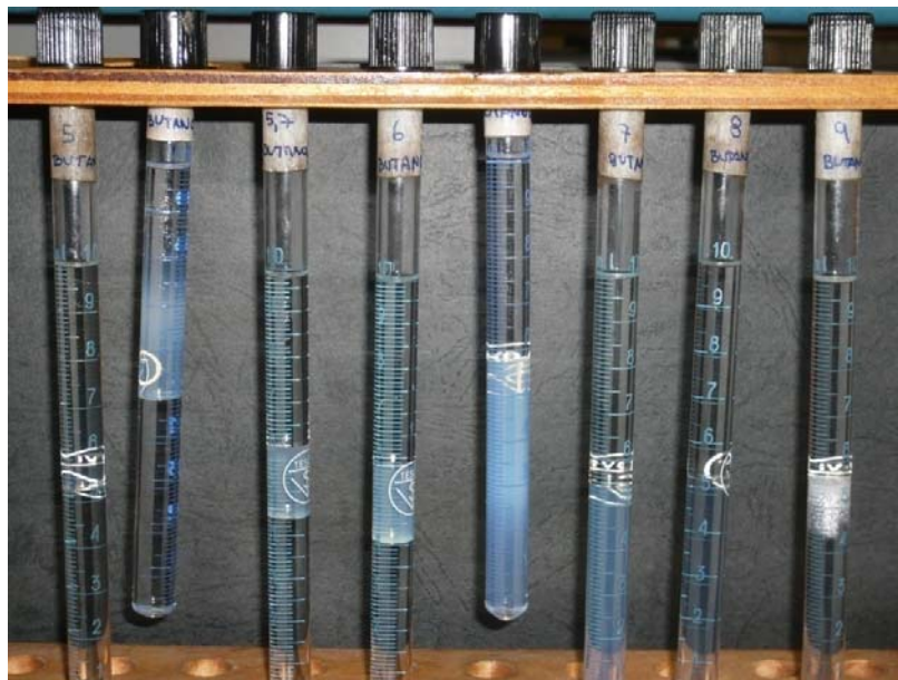
Figura VI. 3. Barrido de EON para el sistema Kerosén-Agua-Surfactante-Butanol
