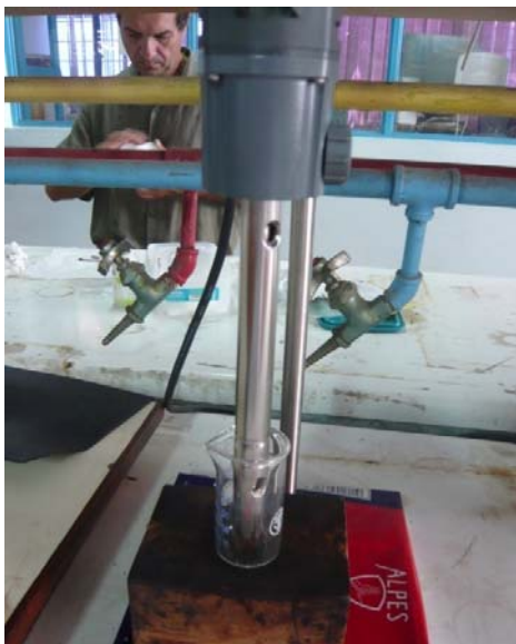
Figura V. 4. Agitador Ultra Turrax
